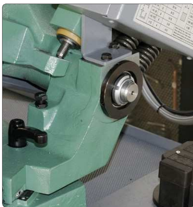
Eccentrico per regolare la perpendicolarità dell'archetto
