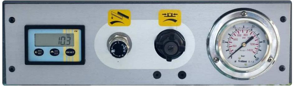
Visualizzazione su display digitale dell'angolo di taglio, regolatore velocità di discesa archetto e regolatore della pressione morsa
