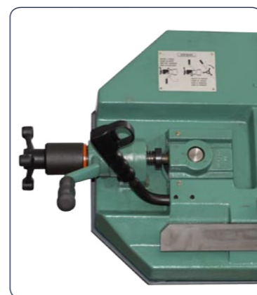
Dispositivo di tensionamento della lama a nastro
