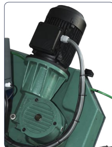
Motore in posizione verticale per ridurre l'ingombro e trasmissione con riduttore 1:40 in bagno d'olio
