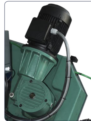
Motore in posizione verticale per ridurre l'ingombro e trasmissione con riduttore 1:40 in bagno d'olio
