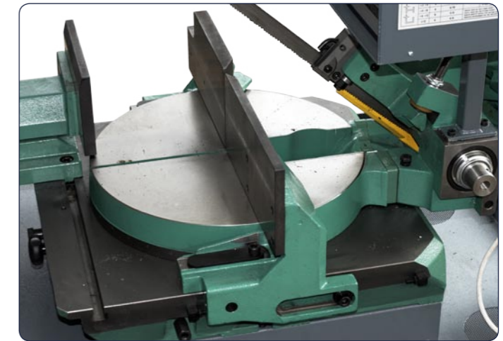
Ampio piano di appoggio circolare rettificato ruotante in solido con l'archetto per un sostegno ottimale del pezzo da tagliare
