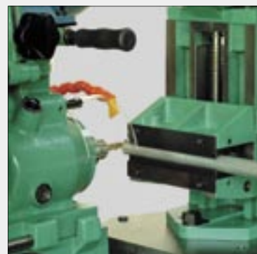
Fresatura di testa tubo. Macchina predisposta per lavorare a 90° rispetto all'asse del pezzo.
