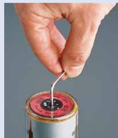
Il periodo di erogazione può essere facilmente regolato da 1 a 12 mesi
